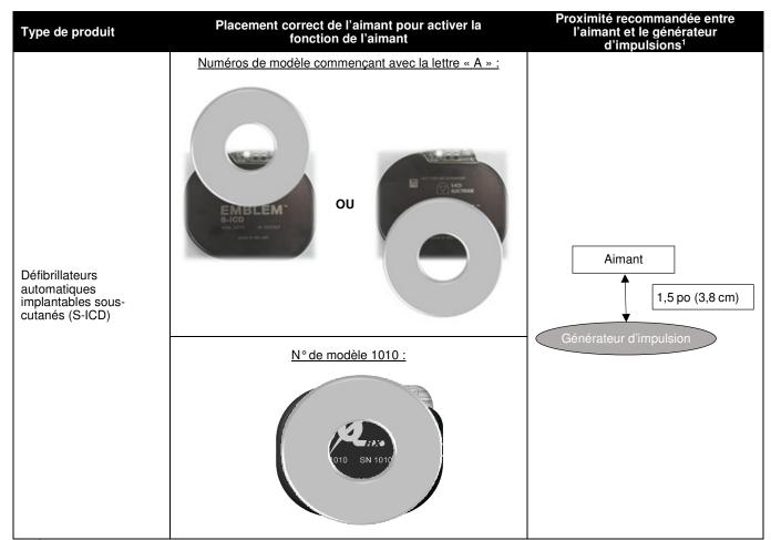
L'aimant torique de Boston Scientific a une intensité de champ minimum de 90 gauss, lorsqu'elle est mesurée à 3,8 cm de la surface de l'aimant.
